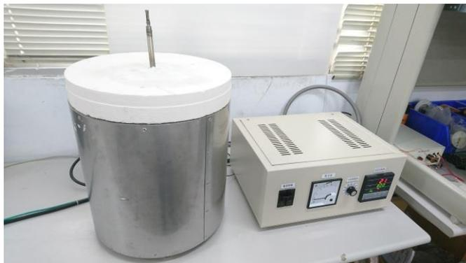
圖 11 高溫加熱爐與電源供應器
